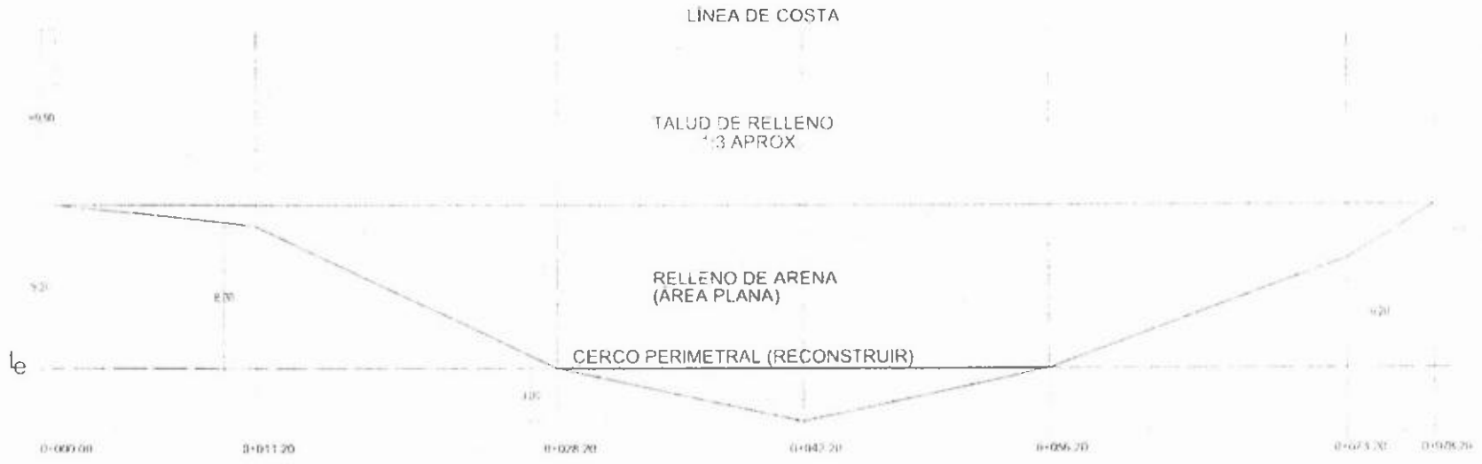
PLANTA DE ÁREAS DE RELLENO ESC. 1:300
